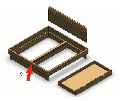
Montieren Sie im nächsten Schritt das Fußteil (9) des oberen Bettrahmens auf den unteren Rahmen.
