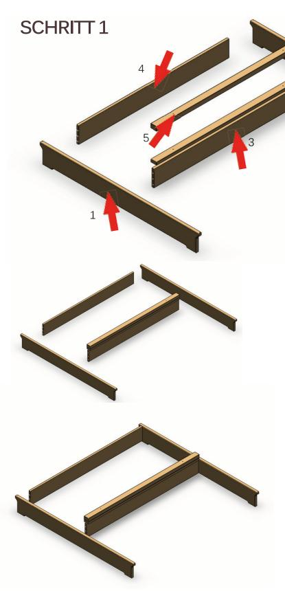
Legen Sie sich das Vorder (1) - und Rückteil (2) des unteren Bettrahmens bereit sowie den Mittelsteg (3) und die Blenden (4).
