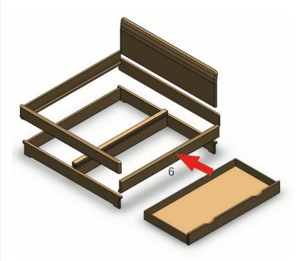
Montieren Sie im nächsten Schritt das rechte Seitenteil (6) des oberen Bettrahmens auf den unteren Rahmen.
