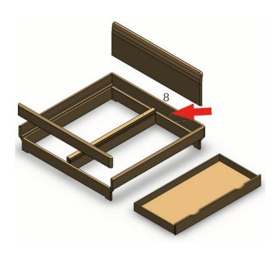
Montieren Sie im nächsten Schritt das Kopfteil (8) des oberen Bettrahmens auf den unteren Rahmen.
