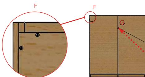
Rückwände in der Mitte mit Schrauben und Unterlegscheiben befestigen.
